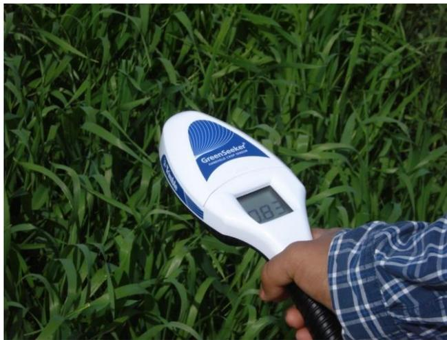
Figura 3.4 Medición de NDVI mediante un sensor portátil.
