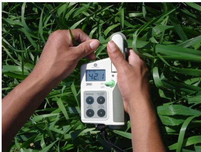
Figura 3.3 Medición del índice de contenido de clorofila en hoja bandera.
