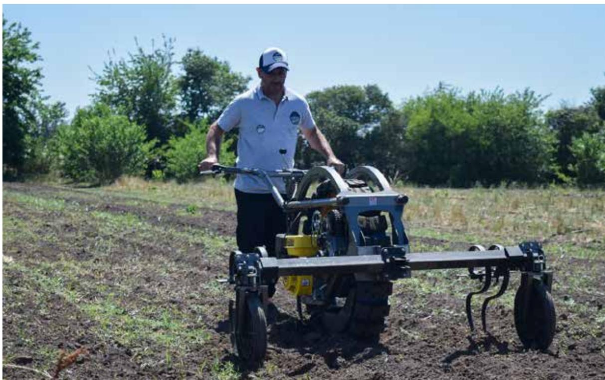
Figura 4. Foto de prueba del microtractor Chango, en situación dinámica utilizando un vibrador para desmalezado del suelo. Fuente: INTA.
