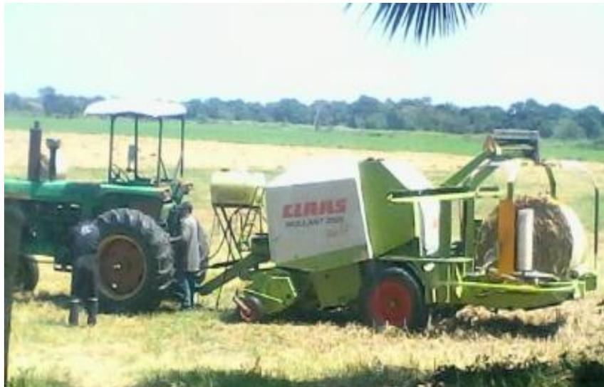
**Figura 5.6 Maquina para realizar rollos de heno y microsilos**
