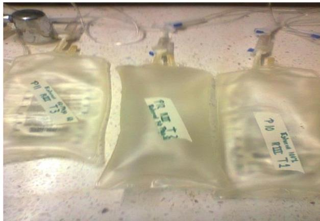
**Figura. No.14. Bolsas usadas como recolectoras de biogás**
