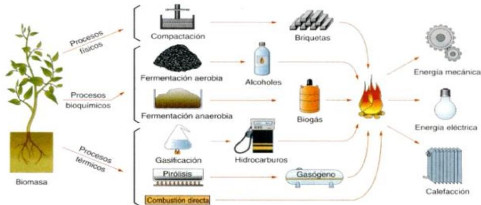
Figura. No.1 Proceso de la biomasa para la generación de bioenergía.
