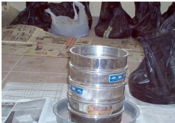
Fig. 3.9 Tamices utilizados para la determinación del tamaño de agregados.
