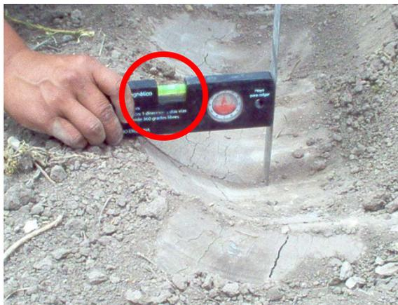
Fig. 3.8 Determinación de la profundidad de trabajo con nivel de mano regla milimétrica
