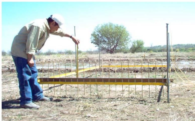
Fig. 3.4. Perfilómetro, utilizado para medir microrelieve del suelo.
