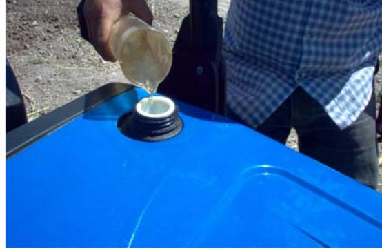
Fig. 3.7 Nivelación del depósito del tractor y medición del gasto de combustible
