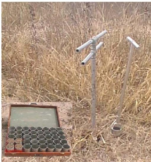
Fig. 3.3. Barrena extractor de núcleos y cilindros
