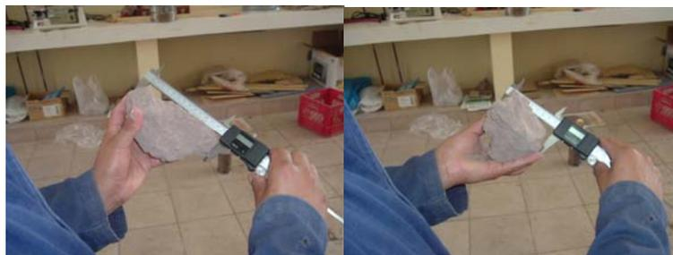
Fig. 3.3 Determinación de longitud, altura y espesor del terrón.
