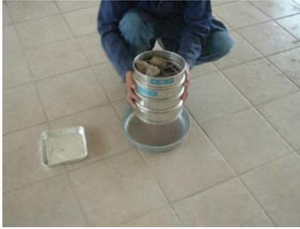
Fig. 3.14 Tamizado en laboratorio.
