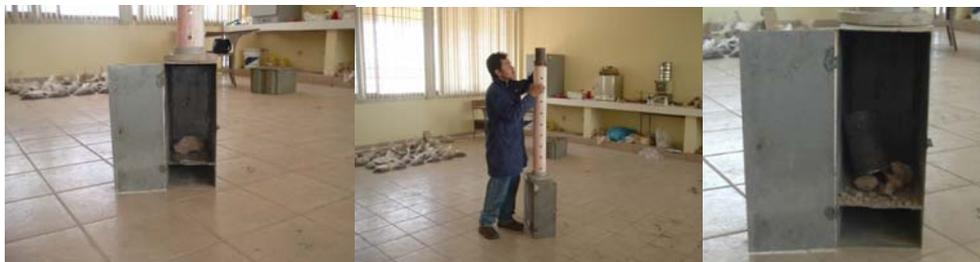
Fig. 3.7 Colocación y fracturación del agregado dentro de la caja de pruebas.
