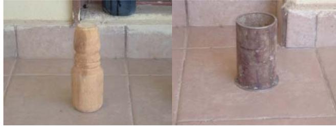
Fig. 3.5 Madera y Metal utilizado para la disgregación del agregado.
