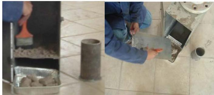
Fig. 3.8 Extracción del agregado.
