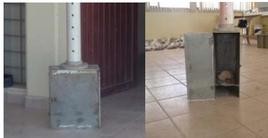
Fig. 3.4 Caja construida y colocación del agregado dentro de la caja de pruebas.
