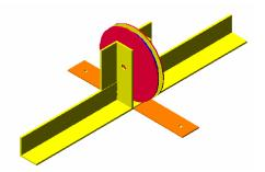
Figura 4.12. Polea con barreno de ½" la cual se encuentra sujeta por medio de dos ángulos.
