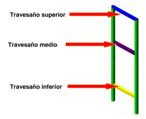
Figura 4.19. Estructura de robot de riego la cual es soportada por el chasis de riego y a su vez sostiene los aguilones por cada uno de sus lados.
