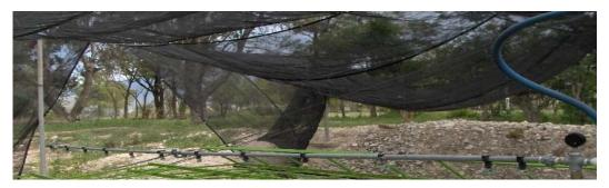
Figura 4.13. Aguilón de robot de riego marca Combi Boom el cual esta sostenido por medio de cables.
