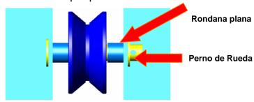
Figura 4.4. Rueda montada en el chasis con su perno, tubos separadores y rondana plana.
