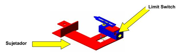
Figura 4.21. Estructura que sujeta al limit switch.
