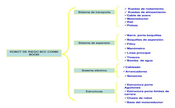
Figura 4.1. Sistemas de los que consta el robot de riego BCC Combi Boom, para su mejor comprensión.
