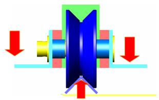
Figura 4.6. Perno del robot que esta soportando el peso de todo el sistema de riego, produciendo así un esfuerzo cortante sobre este.
