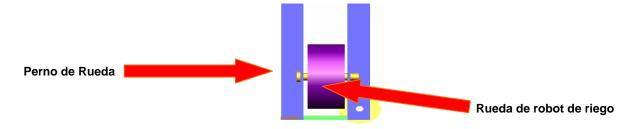
Figura 4.2. Rueda de robot de riego montada al chasis de este con un perno.
