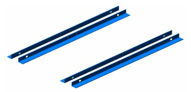
Figura 4.22. Chasis de riego propuesto para el robot de riego el cual consta también de cuatro ángulos de 2"X2"X3/16"
