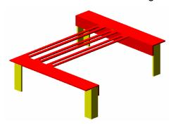
Figura 4.25. Base del motoreductor la cual tiene 4 patas para anclarse al piso con concreto
