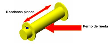
Figura 4.5. Perno propuesto para el robot de riego el cual cuenta con dos rondanas planas y con su respectivo agujero para colocar el pasador.
