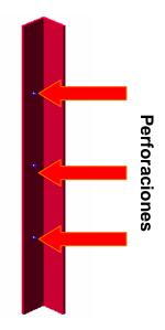
Figura 4.15. Base del aguilón de riego propuesto, con sus respectivas perforaciones para así poder variar alturas de riego.
