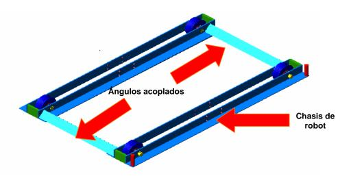
Figura 4.23. Chasis con acoplamiento de dos ángulos de 2"X2"X3/16", los cuales ayudan al movimiento del robot.
