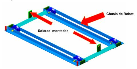
Figura 4.24. Soleras de 2"X1/2" acoplados al chasis, para así montar un cable que moverá al robot completo.
