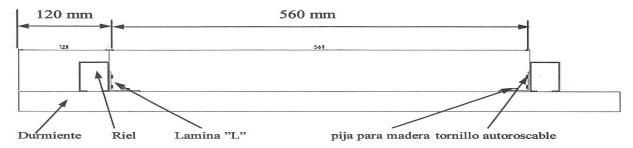
Figura 4.9. Vista frontal del riel de robot de riego Combi Boom, el cual va montado y unido sobre durmientes de madera.
