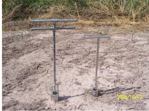
Figura 3.4 Barrena tipo extractor de núcleos
