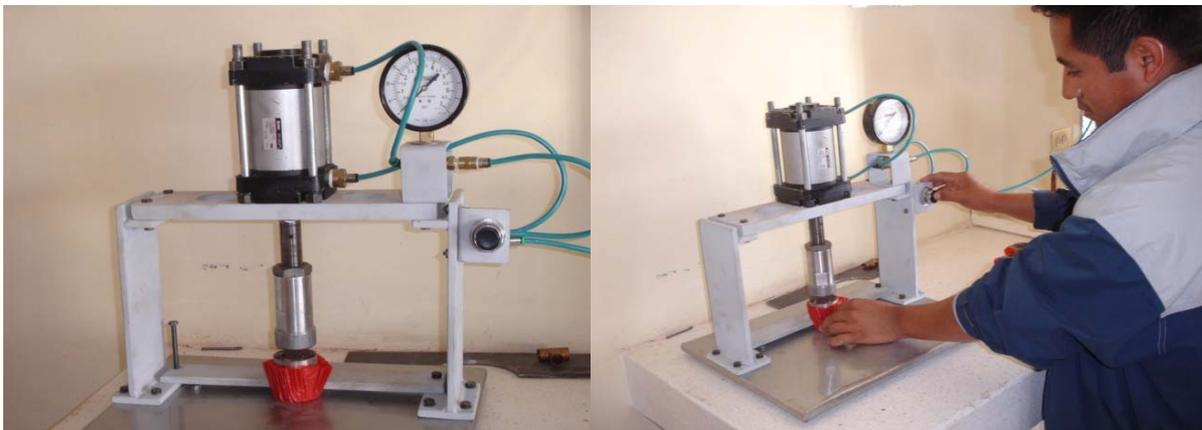
Figura 3.10 Prensa neumática simuladora de compactación.
