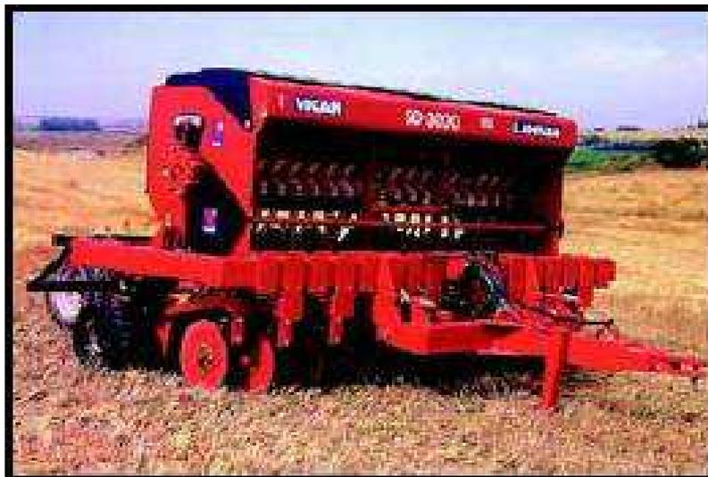
FIGURA 2.4. Sembradora para siembra en líneas a chorrillo.
