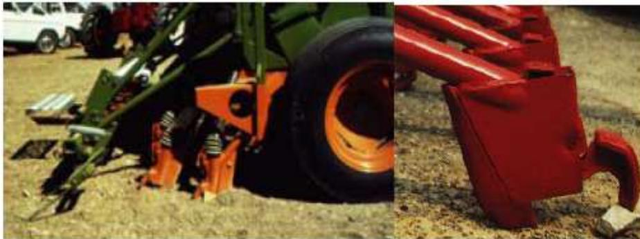
FIGURA 2.27. Botas de enterrado y detalle de la lengüeta.
