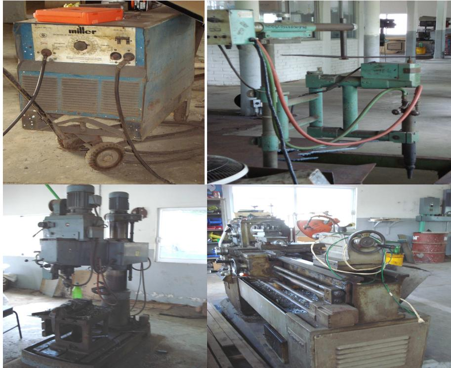
**Figura 3.2. Equipo de taller. Parte superior izquierda, equipo de soldadura eléctrica, pantógrafo, taladro de banco y torno.**
