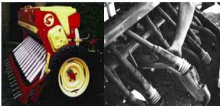
**FIGURA 2.24. Tubo de descarga tipo telescópico.**
