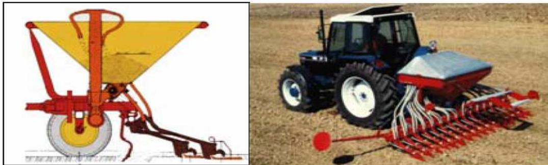
FIGURA 2. 21. Sembradora con distribuidor neumático.
