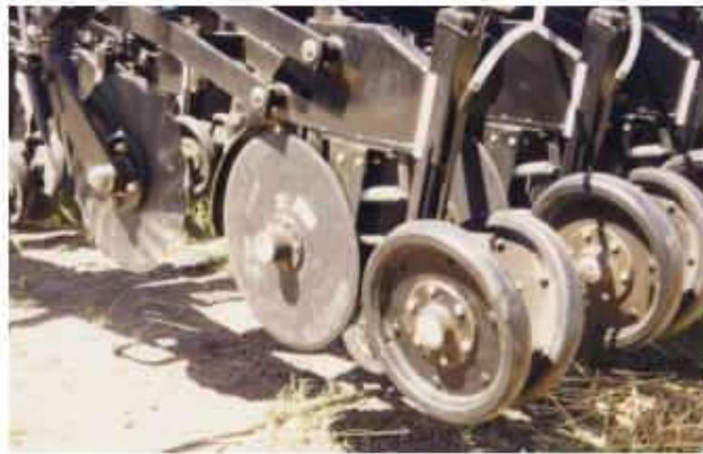
**FIGURA 2.34. Tren de siembra con regulación de profundidad trasera con doble rueda en camellón.**
