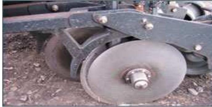
**FIGURA 2.32. Doble disco sembrador desfasado.**
