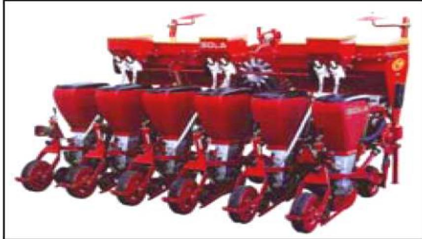
**FIGURA 2.5. Sembradora para siembra en línea a golpes.**
