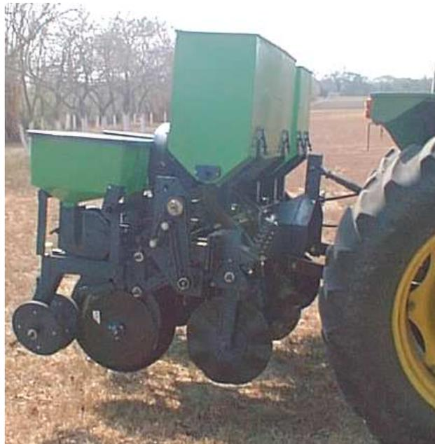
**Figura 4.2. Tren de siembra de sembradora Cotaxtla “V”.**
