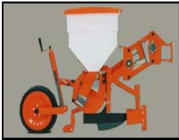
**FIGURA 2.23. Cuerpo de una sembradora de precisión.**
