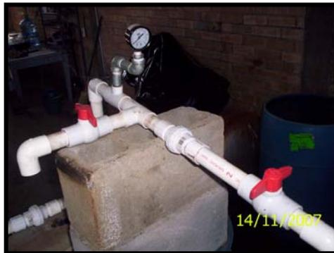
Figura No.17 Válvulas y manómetro para regular flujo.
