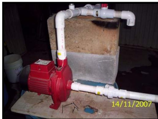
Figura No.16 Bomba centrífuga
