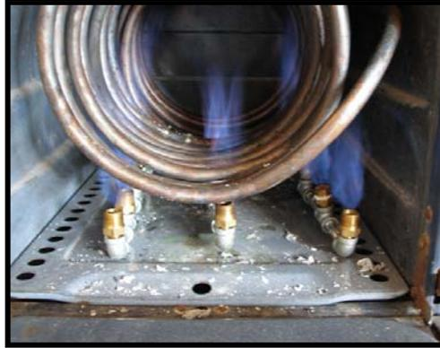
Figura No.19 Intercambiador de calor funcionando
