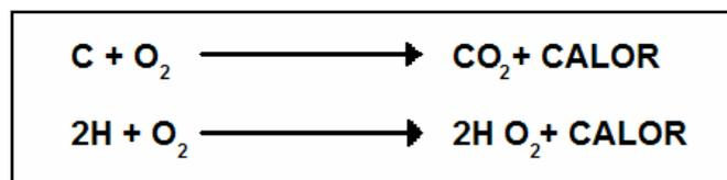
Para que la reacción pueda llevarse a cabo debe alcanzarse la mezcla adecuada de combustible - aire y se debe mantener la temperatura mínima de ignición.
