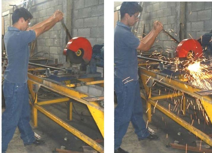
Figura 3.3 Corte de las secciones trazadas.
