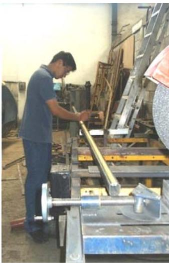
Figura 3.1 Medición del PTR con cinta métrica.
