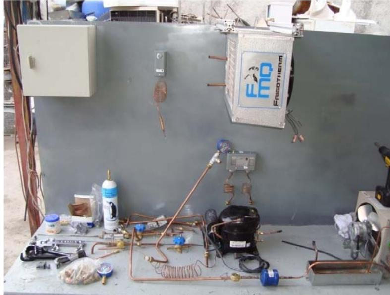
Figura 3.6 Distribución de elementos sobre el bastidor.
