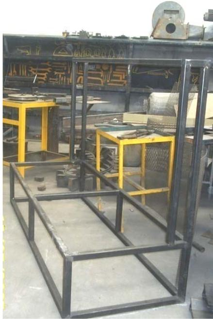
Figura 3.4 PTR unido para conformar el “Bastidor”.
