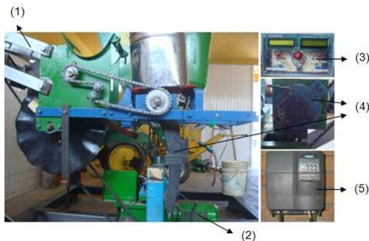
**Fig. 4.1.** Componentes del banco de pruebas.
