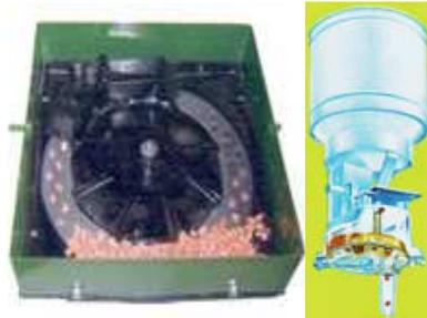
**Fig. 2.2.** Mecanismo de medición con plato horizontal.
