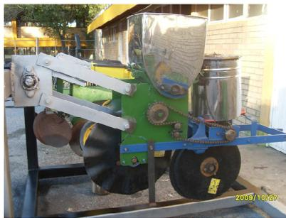
**Fig. 3.1.** Banco de pruebas y sembradora.
