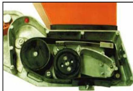
**Fig. 2.5.** Mecanismo de medición con celda de una banda.
