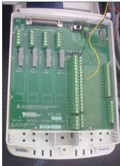
Figura 3.4. Tarjeta de conexiones externas de LabView
