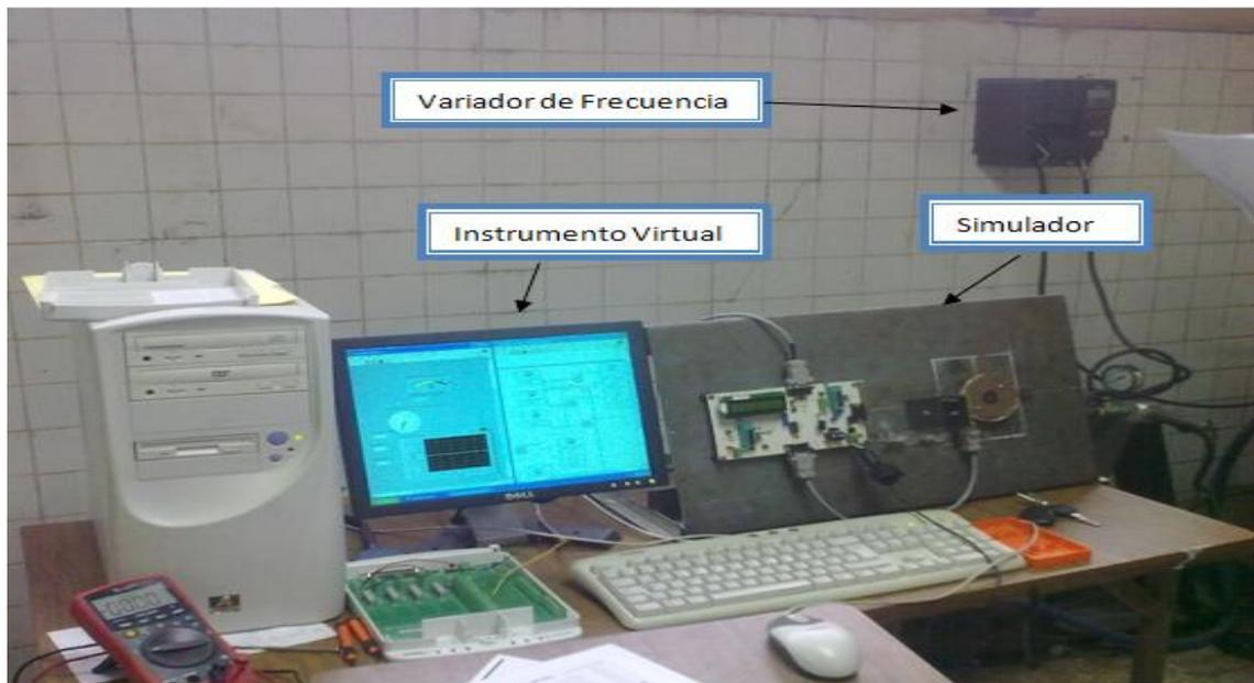
Figura 4.7. Conexiones con el variador de frecuencia.
