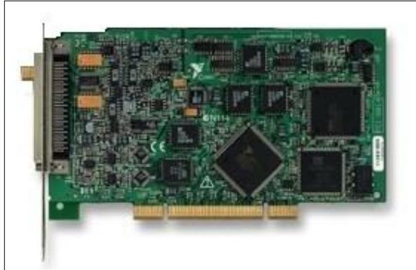
Figura 3.3 Tarjeta de adquisición de datos.
