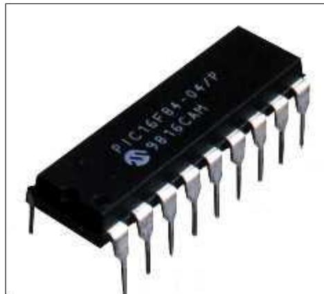
Figura 3.1 Microcontrolador PIC16f844
