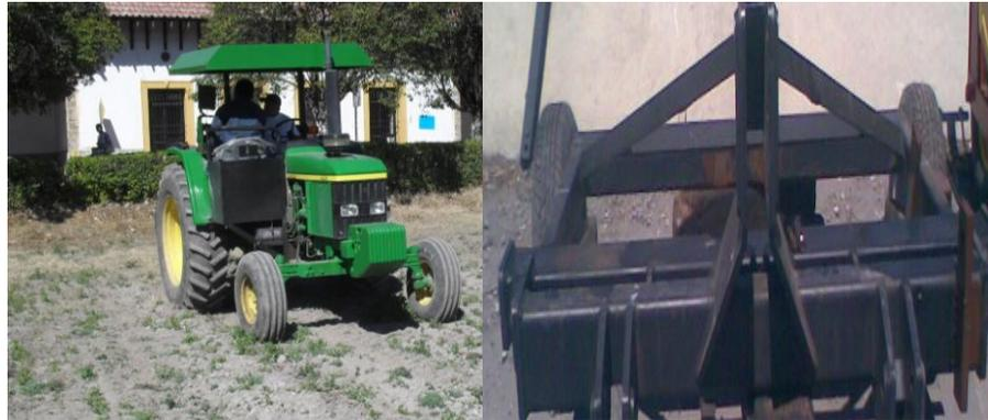
Figura. 3.4 Tractor y carro porta sensores empleados en campo para medir la resistencia al estallamiento.
