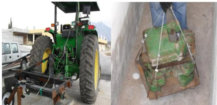
Figura 4.8. Proceso de calibración del sensor octagonal de anillo extendido. (a) tractor con carro porta sensores y transductor de fuerzas de roturación. (b) contrapesos empleados en la calibración.
