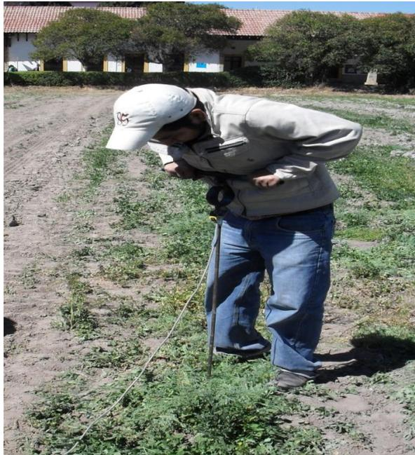
Figura 4.4. Monitoreo de la magnitud de **Fuerza** con Anillo de capacidad de 5 Kn.
