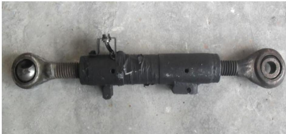
**Figura (3.10) Transductor de fuerzas de 45kN.**
