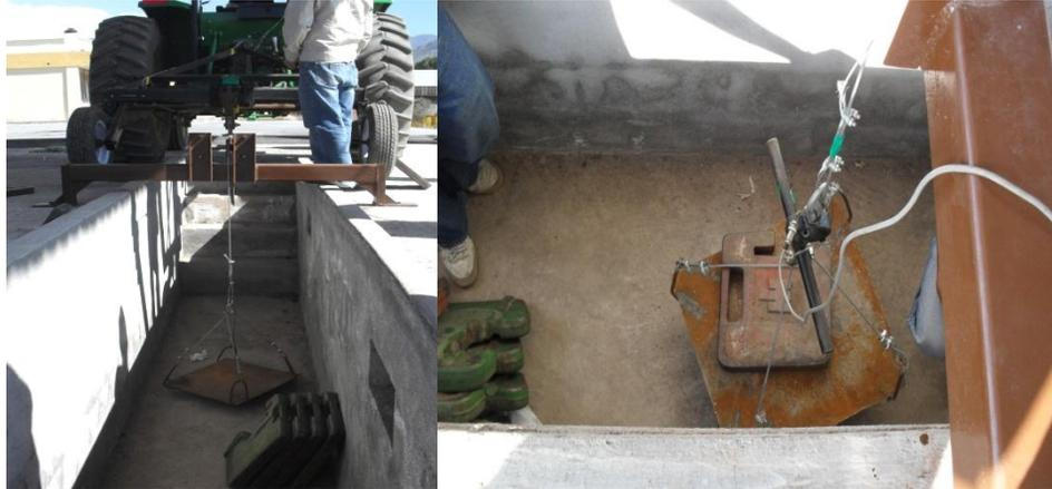
**Figura (3.13) Calibración de los sensores a través de 4 contra pesos.**
