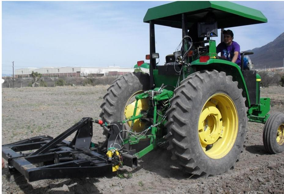
**Figura (3.18) Transductores Octagonales montados en bastidor acoplado al tractor.**
