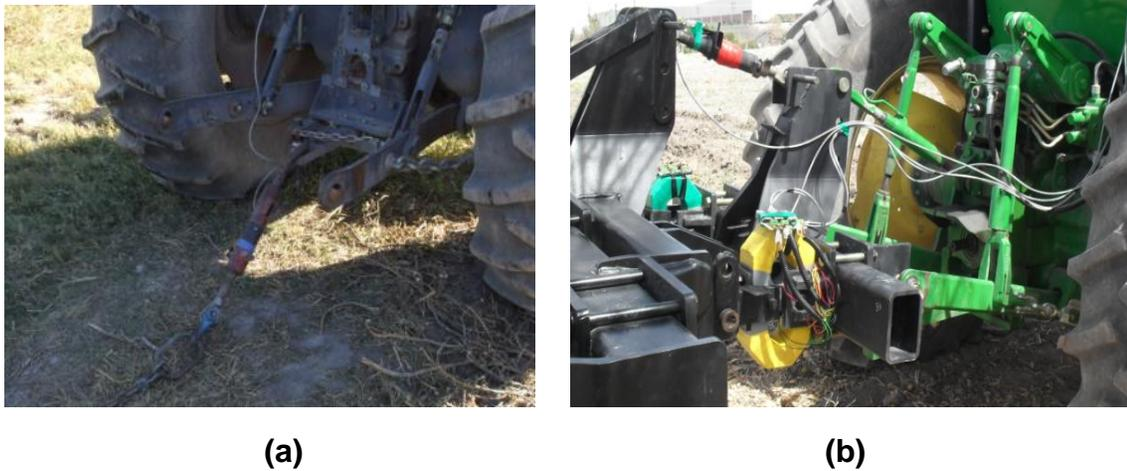
**Figura (4.3) Sensores empleados en la determinación de la fuerza de tiro. (a) Dinamómetro de tiro de 45 kN. (b) Dinamómetro integral de 80 kN.**
