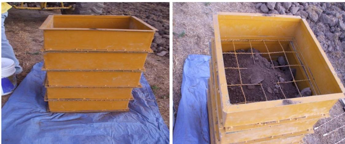
**Figura (3.19) Tamices utilizados para la determinación del tamaño medio de los agregados.**
