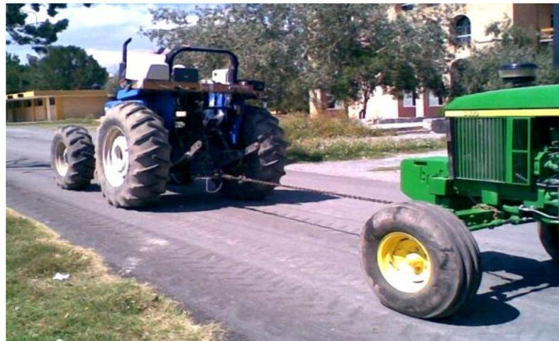
**Figura (3.14) Determinación de la constante de calibración.**
