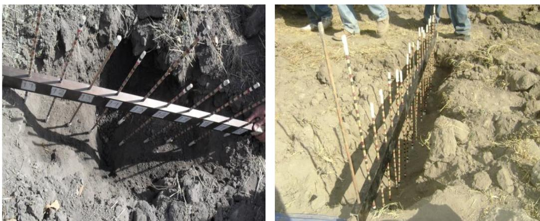
**Figura (3.20) Determinación del área disturbada.**
