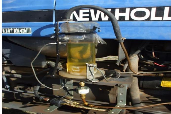
**Figura (3.16) Determinación del consumo de combustible.**
