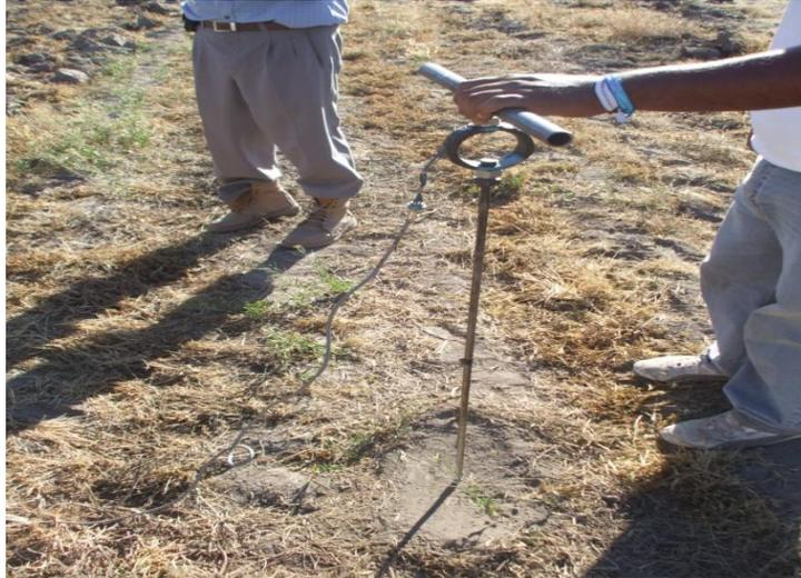
**Figura (3.15) Determinación de la resistencia a la penetración.**
