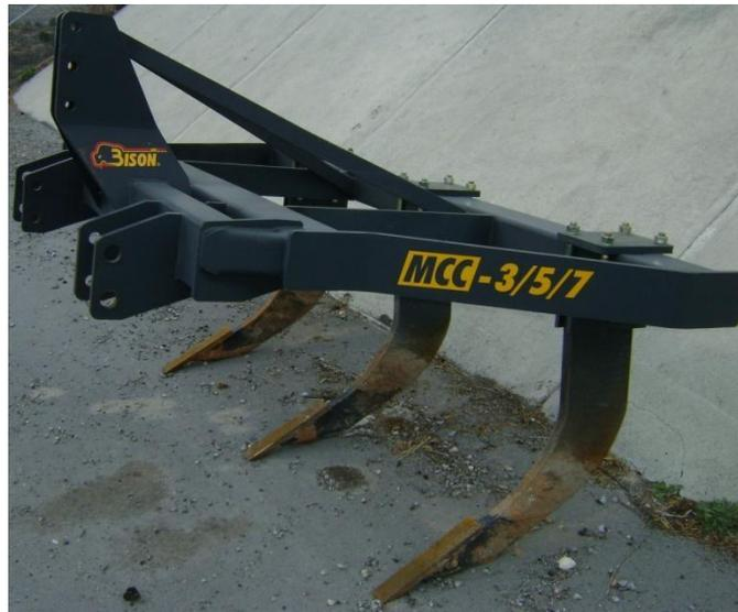
Fig. (3.3). Bastidor MCC 3/ 5/ 7.TECNOMECH S.A de C.V.
