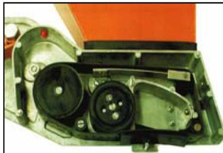
**Figura 2.5** Mecanismo de distribución con celda de una banda.
