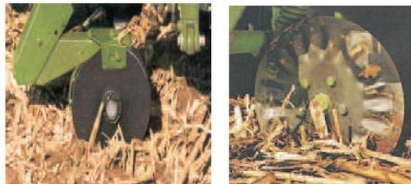
**Figura1.3** Diferentes formas de discos cortadores y removedores de residuos.
