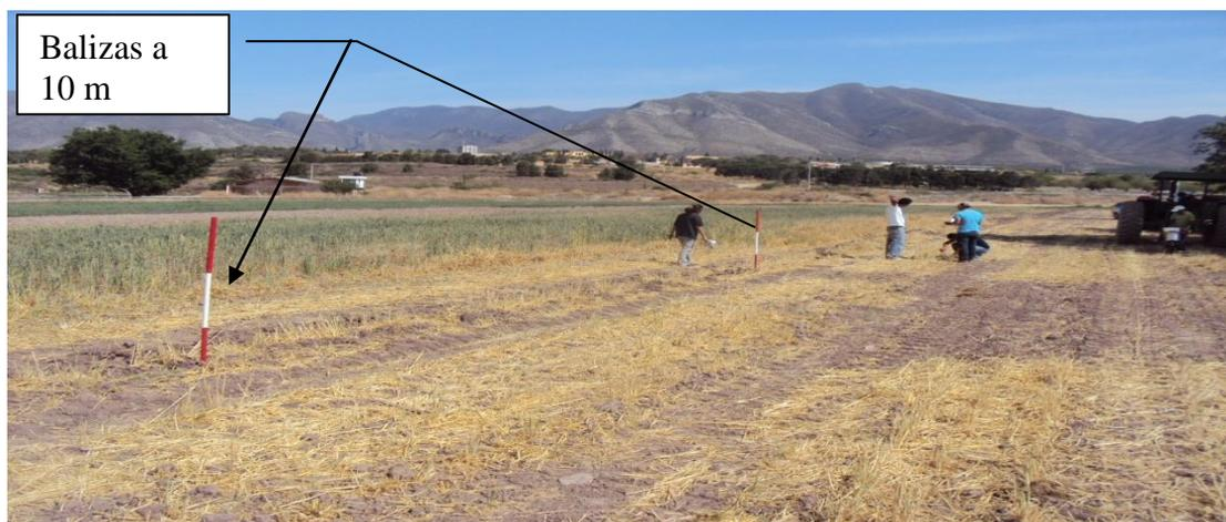
**Figura3.1** Medición de la velocidad de trabajo.
