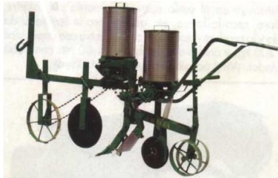
**Figura 1.8** Sembradora abonadora de tracción animal. Fuente: Plegable Maquinaria de tracción animal. FAVECZA.
