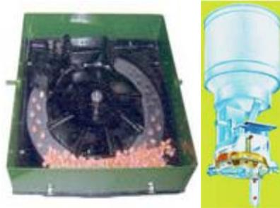
**Figura 2.2** Mecanismo de distribución con plato horizontal.
