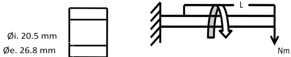
Figura 4.32. Características del sensor de esfuerzo a la falla.
