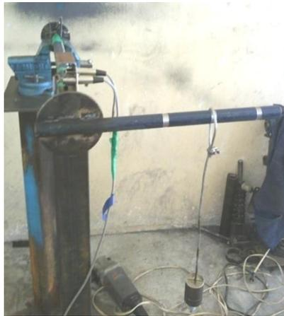
Figura 3.19. Proceso de pruebas en laboratorio del sensor de cohesión y contrapesos empleados en la calibración.
