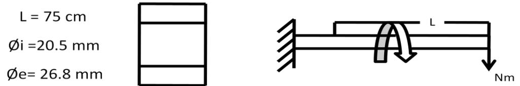
Figura 3.15. Barra de torsión para el sensor de cohesión y sus radios.
