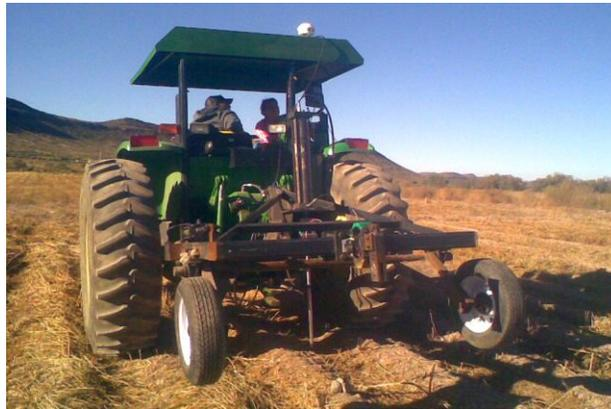
Figura 3.13. Tractor y carro porta sensores empleados en campo para medir la resistencia a la penetración.
