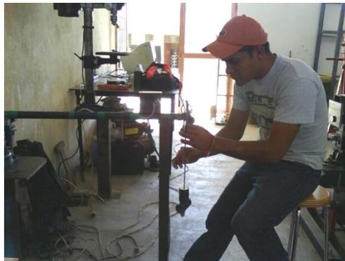
Figura 4.38. Procedimiento en cargas y descargas de los diferentes pesos del sensor de cohesión.
