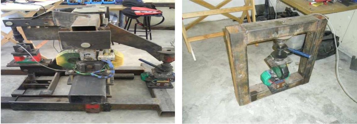
**Figura (4.2) Calibración de los sensores.**
