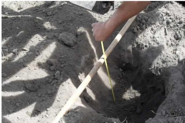
**Fig. 3.13. Medición de la profundidad de trabajo.**
