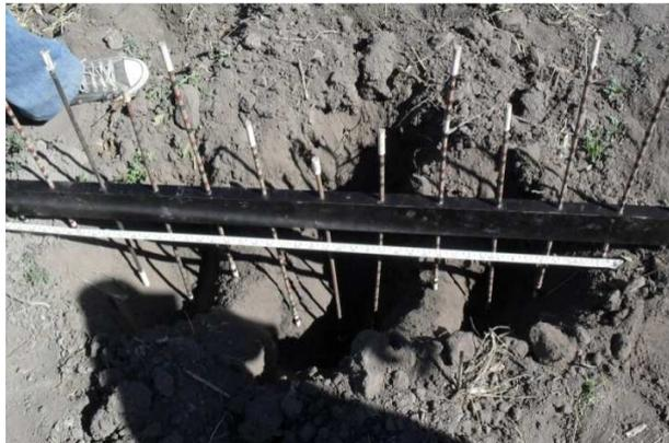
**Fig. 3.12. Medición del ancho de trabajo.**
