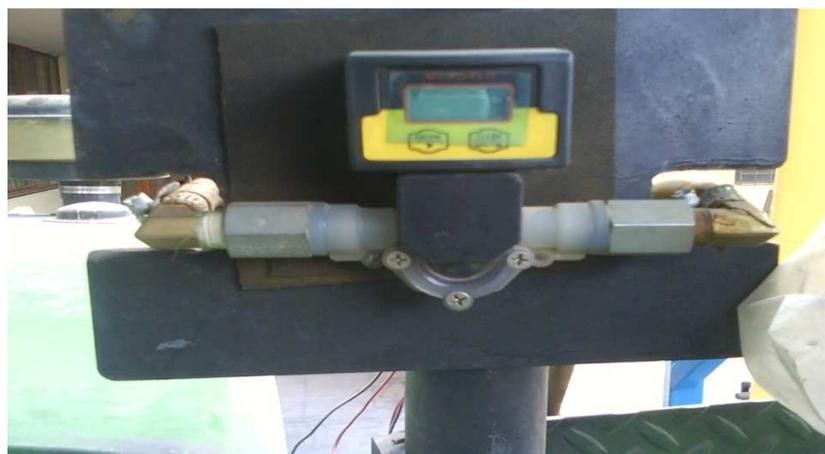
**Fig. 3.7. Sistema para medir consumo de combustible.**
