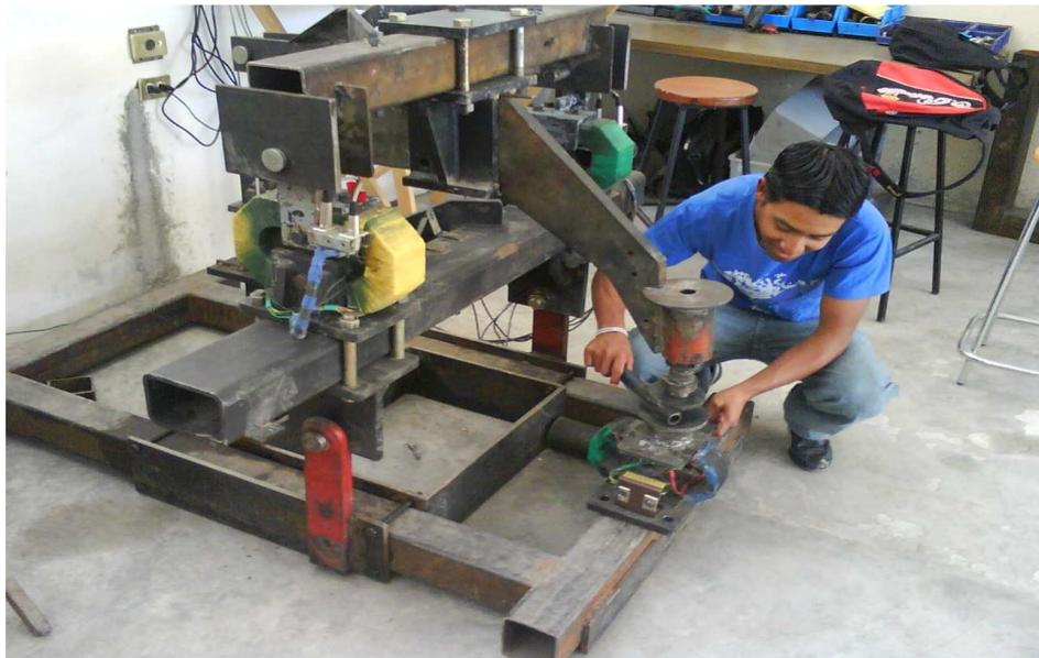
**Fig. 3.4. Calibración de los sensores a través del banco de prueba.**
