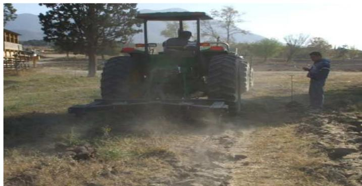
**Fig. 3.8. Medición de la velocidad de avance.**
