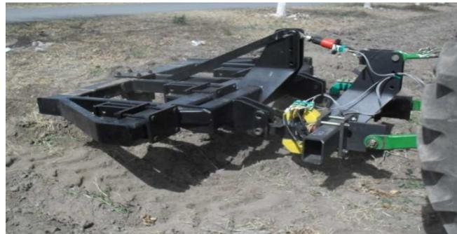
**Fig. 3.9. Medición de la fuerza a través del sensor octagonal.**
