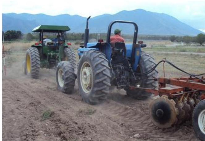
**Figura 12. Fuerza de arrastre del implemento (rastra de discos) acoplado al tractor.**
