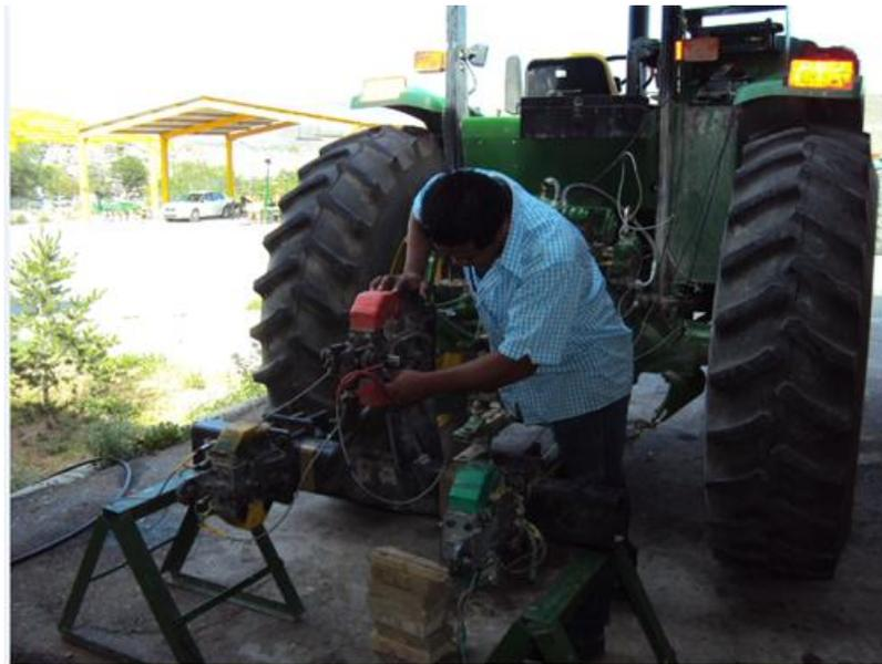
Figura 20. Posición de los sensores para la prueba en campo.
