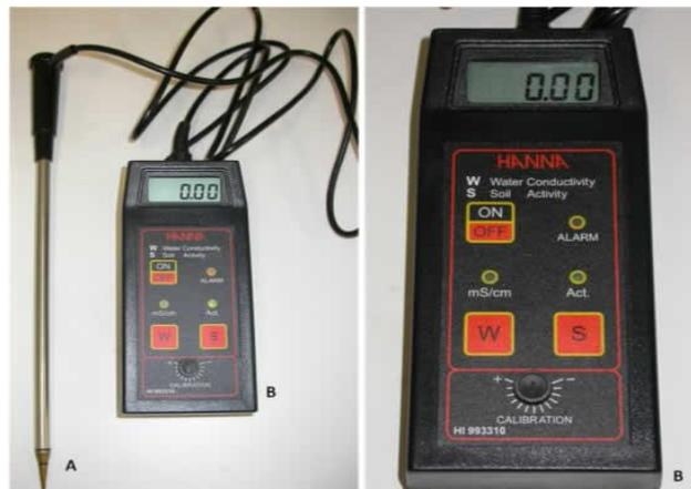
**Figura 2. 8** Actinómetro de HANNA Instruments (HI993310): para medir la conductividad eléctrica de una disolución (W) ó la actividad del suelo (S).
