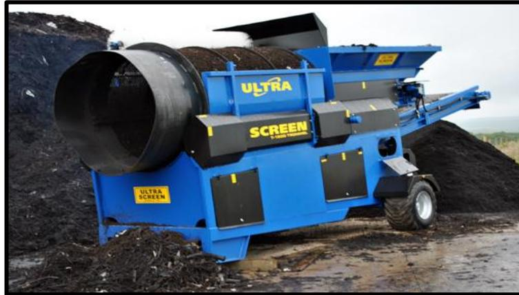
Figura 2.2 Maquina Trommel 612 W tipo cilindro rotatorio.
