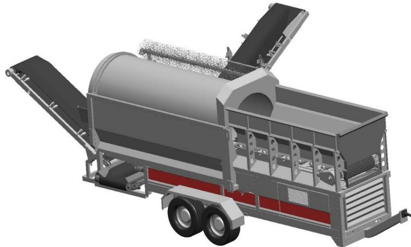
Figura 2.3 Ultra screen tipo cilindro rotatorio.
