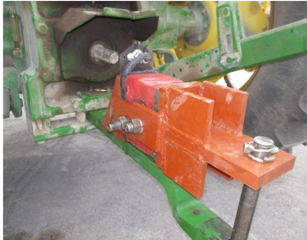
**Figura 3.15. Sensor acoplado a la barra de tiro junto con la rastra.**
