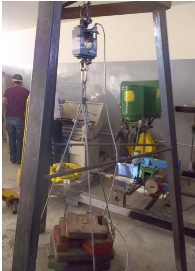
*En la figura 4.1 muestra la forma en que se llevó a cabo la calibración del sensor.*
