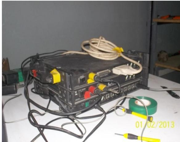
**Figura 3.4 Amplificador de señal DBKA43a**
