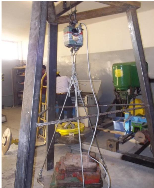
**Figura 3.5 Tripie con plataforma para suspensión de pesos.**
