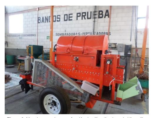
Figura 3. Maquina a evaluar con función de trilla y limpieza de Higuerilla.
