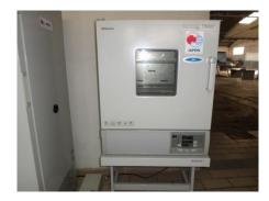
**Figura 10.** Horno de secado utilizado en la prueba.
