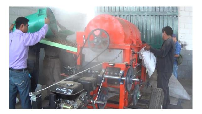
Figura 7. Alimentación a la maquina trilladora.
