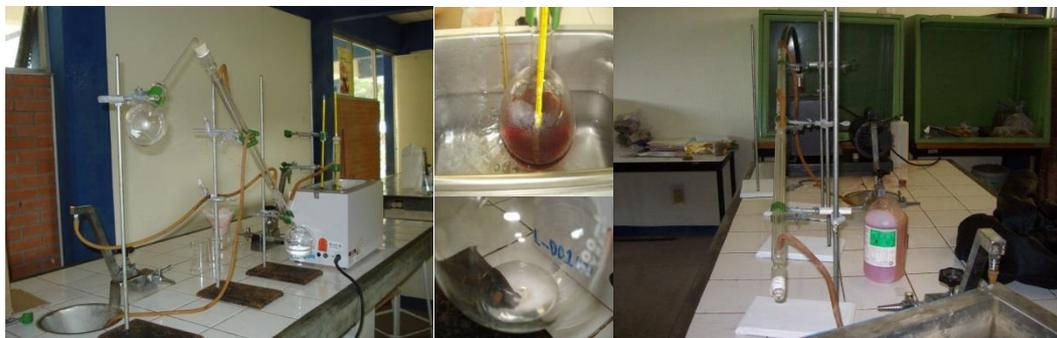
**Figura 3.6. Concentración del pigmento mediante destilación a presión reducida.**
