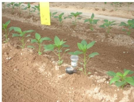
**FIG. 3.** Sensores de humedad.
