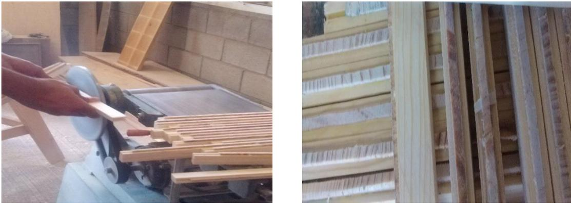
Figura 3. Muestras de *Pinus oocarpa* Schiede en el proceso de lijado que permitirán una mejor observación de los anillos de crecimiento en el microscopio.
