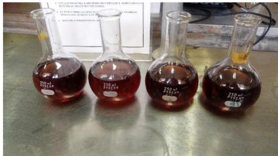
**Figura 8.** Determinación de Demanda Bioquímica de Oxígeno.
