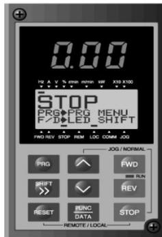
**Figura 5.22** Display en el teclado al conectar la alimentación.
