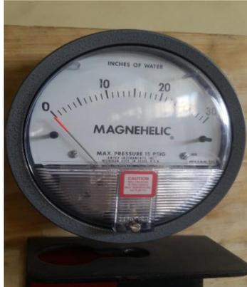
**Figura 5.16** Unidad de medición de presión diferencial.
