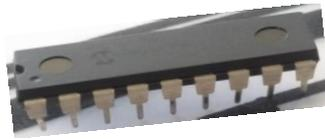
**Figura 5.2** Microcontrolador PIC16F84.
