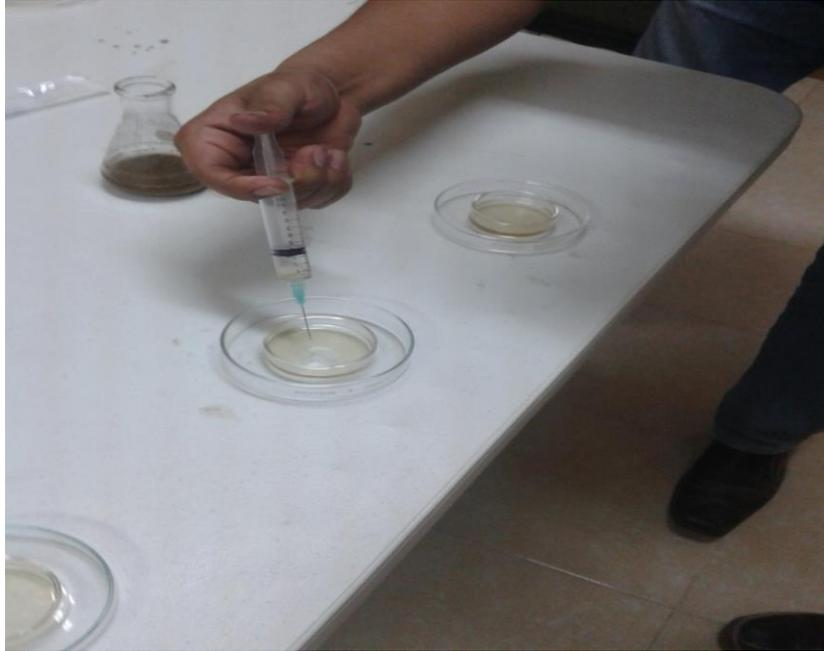
**Figura 15.** Colocación de extracto en cajas petri para recorrido final de cromatografía
