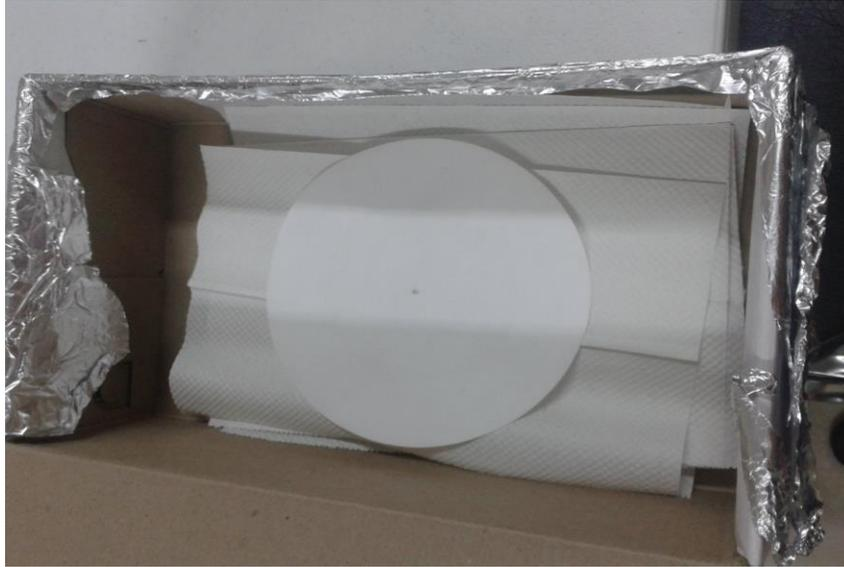
**Figura 13.** Cámara de secado y revelado para el reactivo nitrato de plata
