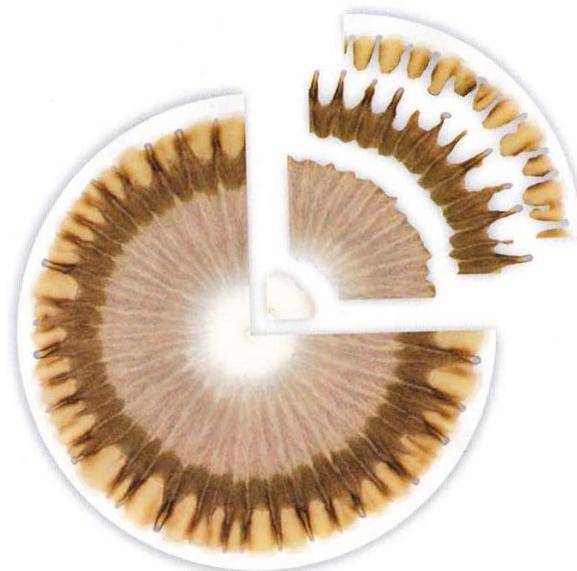
**Figura 2.** Separación de las diferentes zonas en una cromatografía perteneciente a un abono orgánico en proceso de elaboración (Fuente: Restrepo & Pinheiro, 2011)
