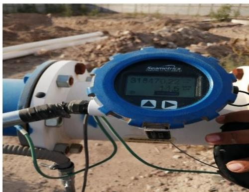
*Fig. 1 Medidor de flujo*
