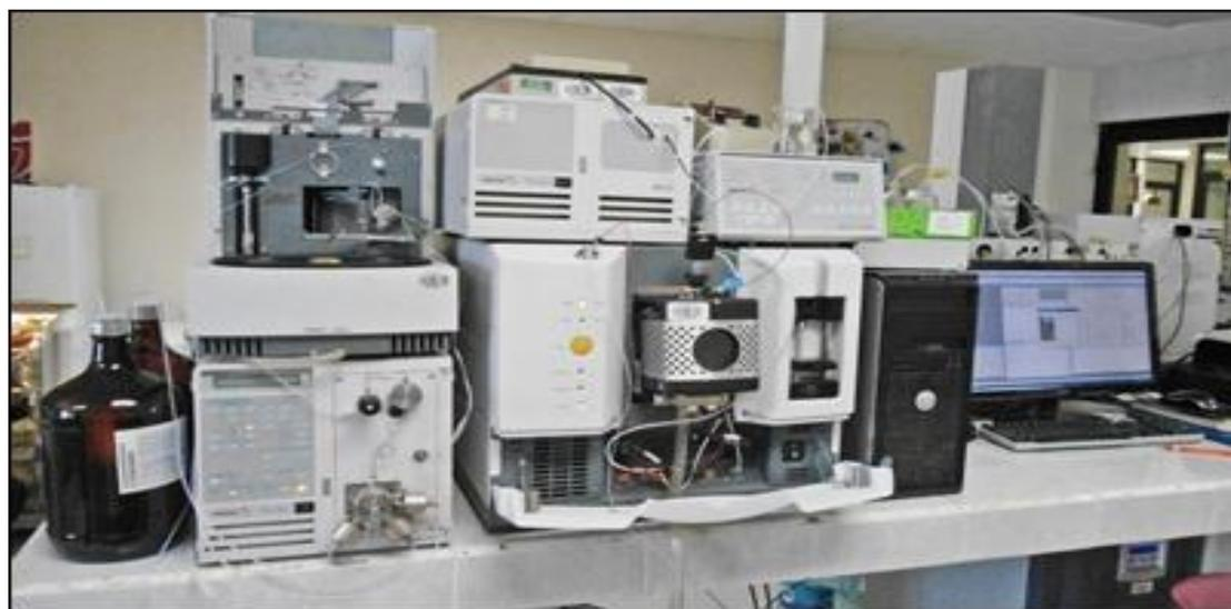
**Figura 3.18.** Cromatógrafo líquido de alta resolución, acoplado a masas.
