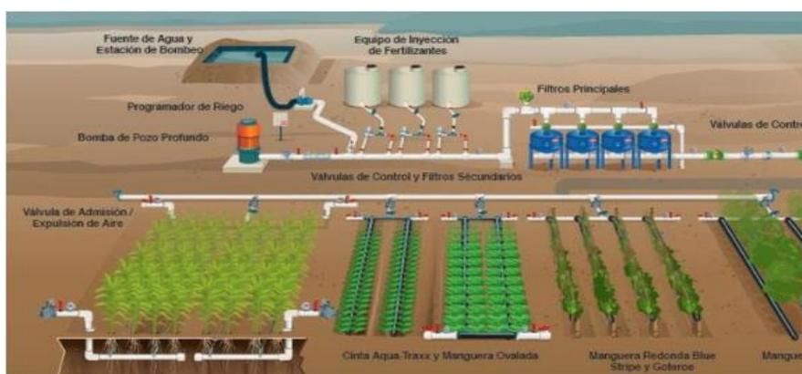
Figura 2. Sistema de riego con estanque de almacenamiento y pozo profundo
