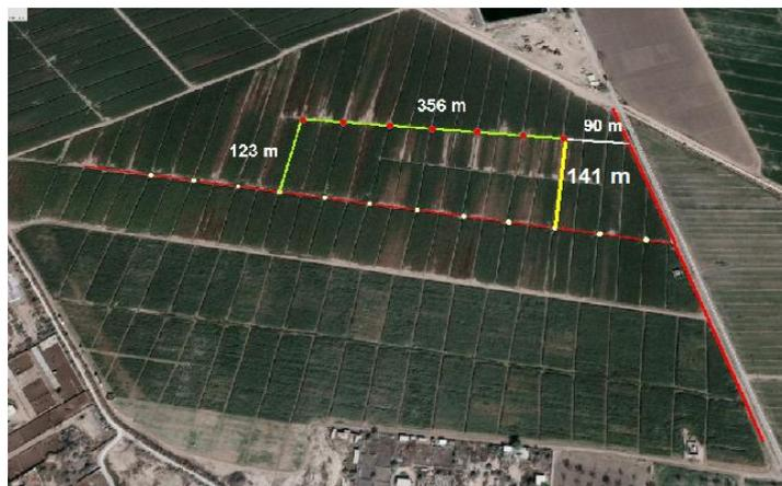
Figura 7. Diseño de línea de hidrantes instalada en predio San Sergio cuatro
