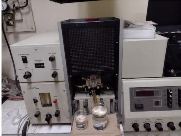
Figura 16. Espectrofotómetro de absorción atómica, Perkin Elmer 2380
