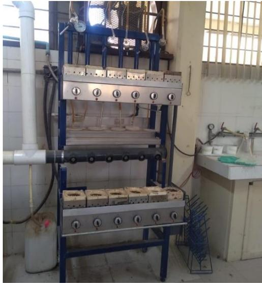
Figura 14. Digestor y destilador Kjeldahl Modelo: KGU-COMB
