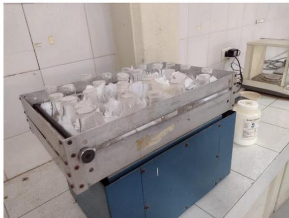
Figura 15. Agitador de acción reciproca Eberbach Modelo: E6010
