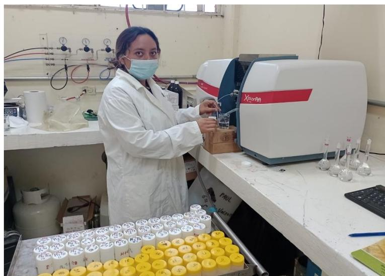
**Figura 3.** Análisis de las muestras en el espectrofotómetro de absorción atómica (Marca: GBC Modelo: XplorAA). Laboratorio de Fisiología Vegetal del Departamento de Horticultura.
