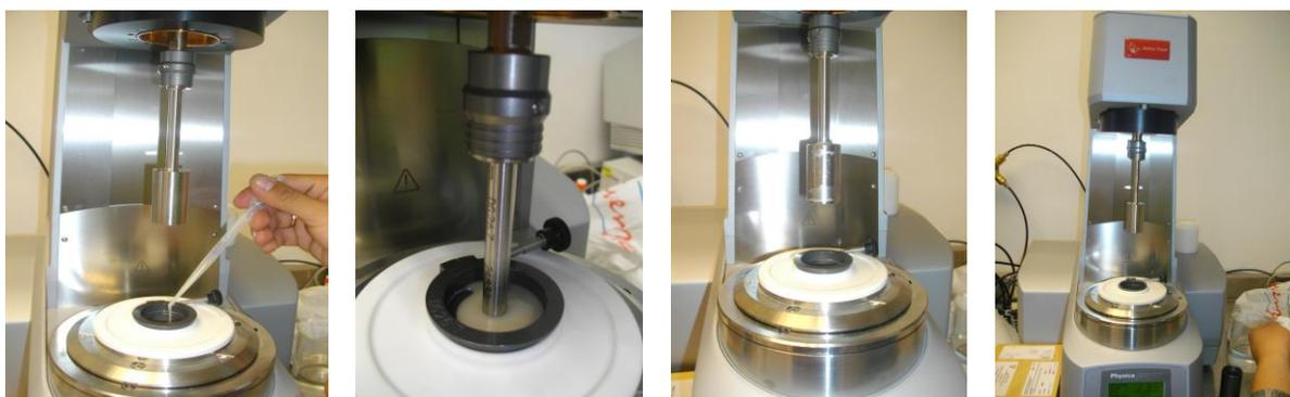
Figura 6: Determinación de viscosidad del recubrimiento utilizando un Reómetro rotatorio, MCR-301 de Antón Paar. Temperatura 20 °C.
