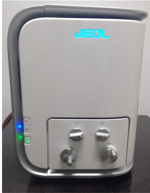
**Figura 9.** Imagen del microscopio electrónico de barrido JMC 6000 marca JEOL .
