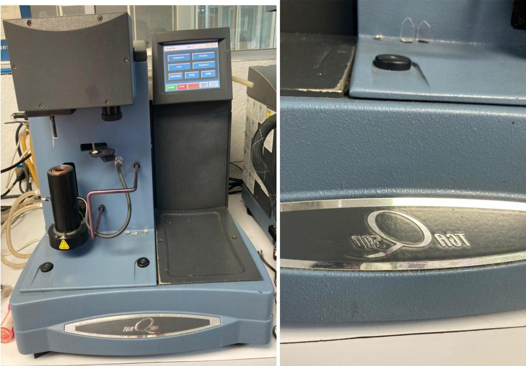
**Figura 8.** Imagen del equipo de análisis termogravimétrico TGA.
