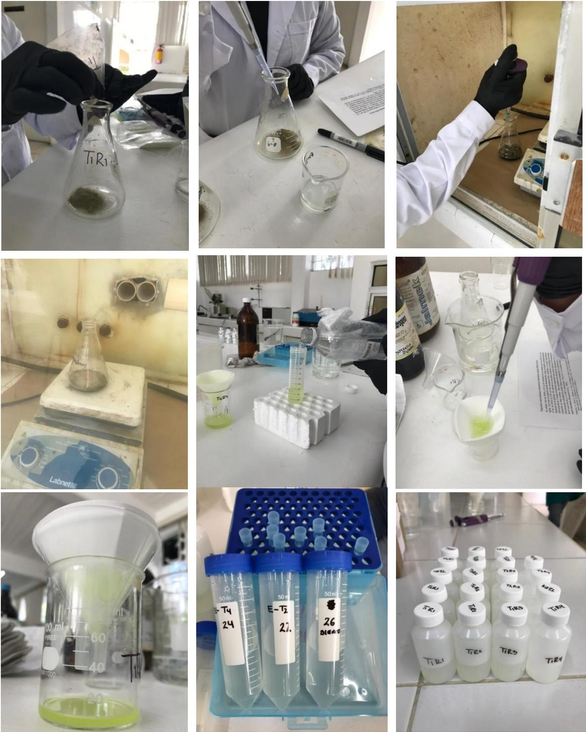
Figura 8. Digestión de muestras para determinar el contenido de minerales.
