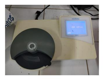
Figura 8. Fotómetro utilizado en el CIPA-UL, para medir concentración espermática.
