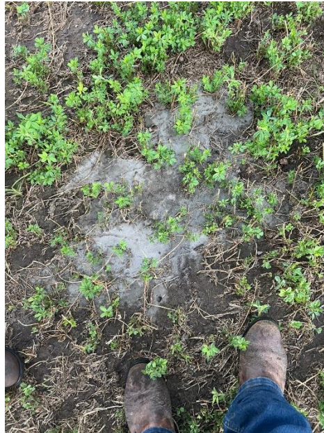
Figura 16.- Arena extraída por los pozos
