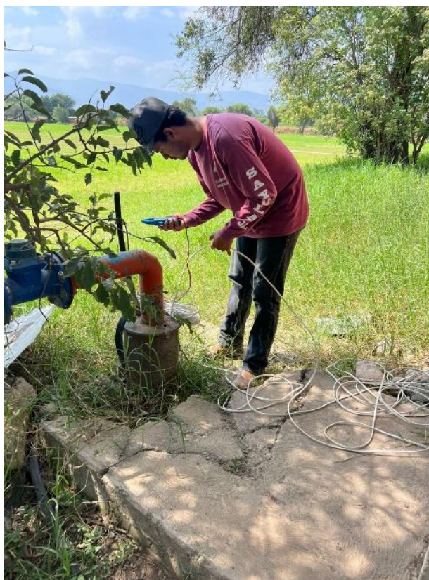
Figura 12.- Medición de nivel estático.
