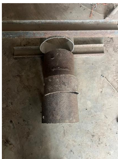
Figura 14.- Recortes que se han hecho en el ademe de un pozo.
