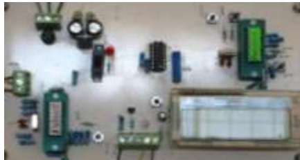
Figura 3.15.- Dos tarjetas electrónicas para recibir señal de los sensores de caída de semilla.
