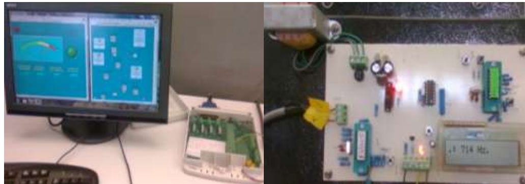
Figura 4.10.- Conexión para hacer la verificación de los Microcontroladores (PIC16F84) de frecuencia y caída de semilla.
