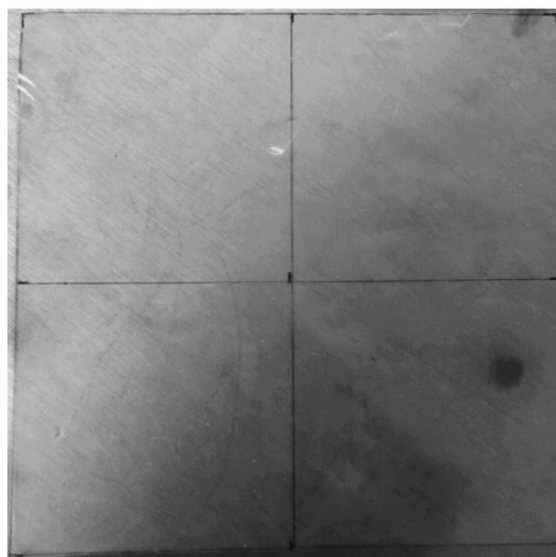
Figura 4. Película obtenida a partir de almidón modificado y 0.25% de microfibras de lechuguilla ( A. lechuguilla Torr.). Obtenida sobre un fondo de placa de acero inoxidable.
