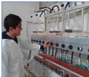
Figura 8.- Utilización de método Kjeldhal, determinación de proteína
