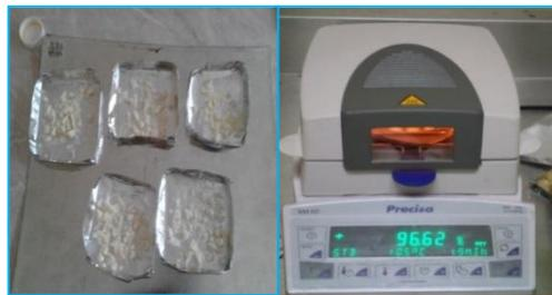
Figura 2.- Analizador de Humedad Precisa Mod. XM50
