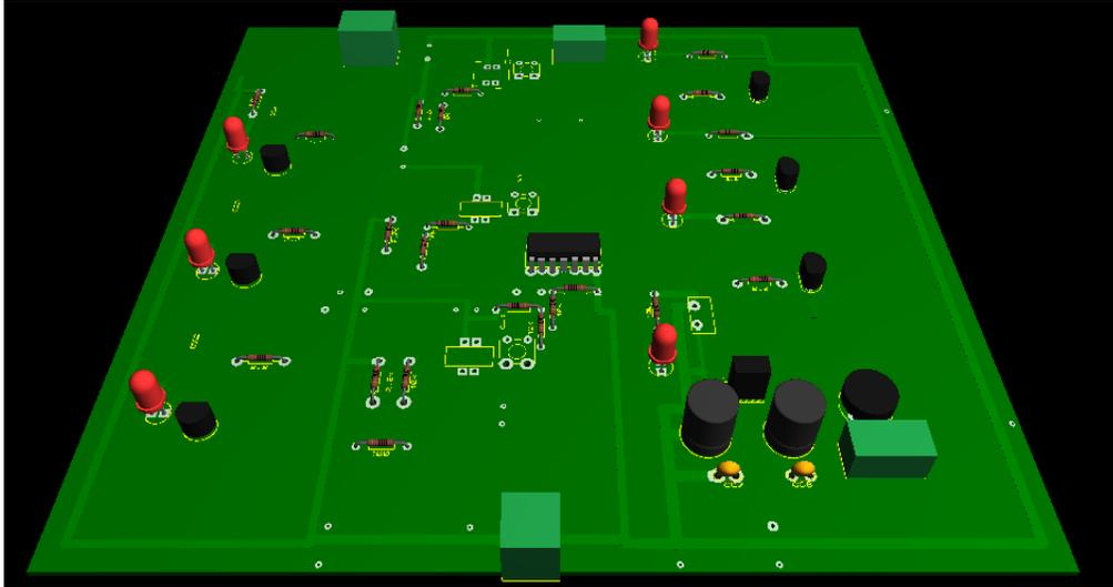
Ya que se soldaron todos los componentes, se continuó con la verificación del correcto funcionamiento de la tarjeta, para esto se conectó al PLC y aun protoboard que regula la alimentación de voltaje tanto a la placa como al PLC. De la tarjeta salen 5v enviados al protoboard y este manda 24 al PLC, del PLC salen 24v que son enviados al protoboard este envía 5 a la tarjeta para la simulación de los ejercicios.
