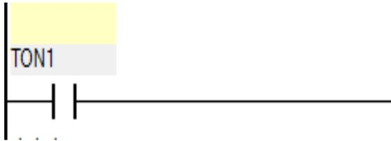
11. Después asignamos la bobina
