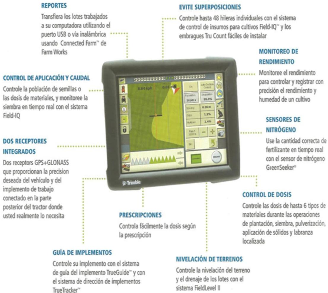
Figura 2. 15 Funciones de la pantalla FMX. (Agrolaser nivel S.L., 2014).
